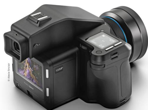
**Das Phase One XF IQ3 100MP Kit besteht aus dem neuen erweiterbaren Kameramodell XF und dem IQ3-Back mit 100 Mpx-CMOS-Sensor.**
